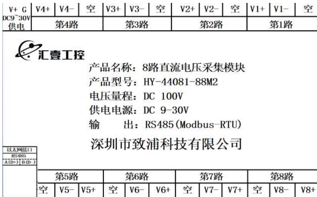
图 5.1 以太网口电压输入产品引脚定义图(带 RS485 口)
